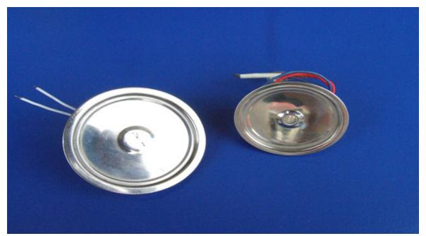
PTC热敏电阻除用作加热元件外,同时还能起到"开关"的作用,兼有敏感元件、加热器和开关三种功能,称之为"热敏开关". 电流通过元件后引起温度升高,即发热体的温度上升,当超过居里点温度后,电阻增加,从而限制电流增加,于是电流的下降导致元件温度降低,电阻值的减小又使电路电流增加,元件温度升高,周而复始,因此具有使温度保持在特定范围的功能,又起到开关作用. 利用这种阻温特性做成加热源,作为加热元件应用的有暖风器、电烙铁、烘衣柜、空调等,还可对电器起到过热保护作用.
